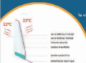
En simple ou en double vitrage, le vitrage chauffant vous apportera une chaleur homogène et vous permettra de supprimer vos radiateurs
